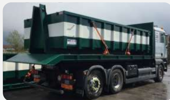
Conteneur à déchets chargé sur plateau ( plateau chanfreiné à l'arrière )
