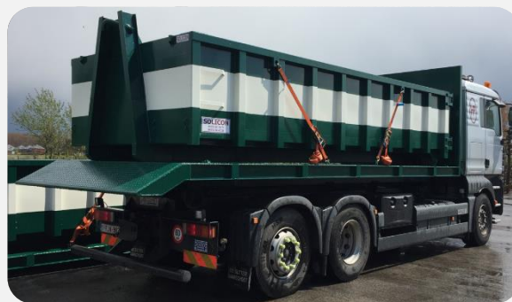
Afvalcontainer geladen op plateau (plateau achteraan afgeschuind)
